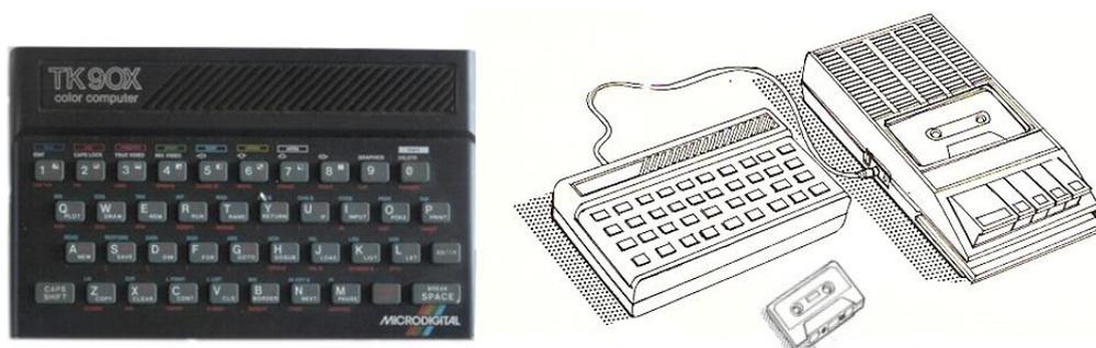
**Figura 2:** O aplicativo FUNÇÕES foi programado em uma unidade de processamento TK-90X com 48 Kbytes de memória que, acoplada a uma televisão, utilizava como unidade de leitura um gravador de fita cassete. Na imagem, uma fotografia do computador utilizado nas minhas experiências e um dos muitos esquemas pictóricos contidos em seu manual de operação. (TK-90X, 1985 p.1-16)
